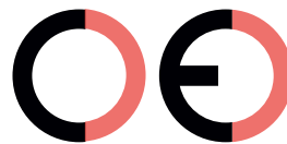
Marca CE falsa (demasiado separados)
